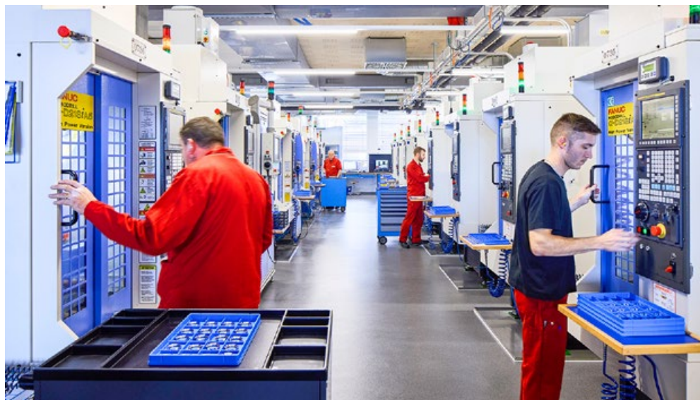
Les machines de production CNC extrêmement sensibles sont refroidies avec le froid process (ci-dessus). La centrale frigorifique est logée dans le sous-sol (en haut à gauche). Le nouveau centre névralgique du site est le « hub » (à gauche).
