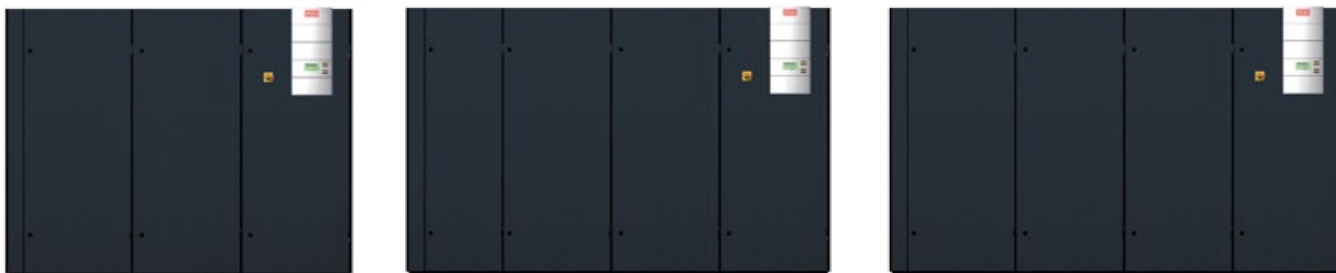
Climatiseurs CyberAir 3 avec taille de porte standardisée disponibles en versions à basse consommation énergétique ou à encombrement réduit. Les sept tailles disponibles présentent une largeur comprise entre 950 et 3 350 mm. Les deux tailles les plus grandes présentent une profondeur de 980 mm.
